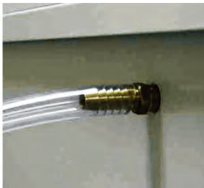
集尘效率测定用喷管安装
