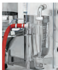
在旋风分离部配置有防止烫伤的安全盖及除静电刷。
